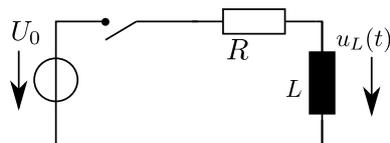
Die zunächst ungeladene Induktivität wird durch Schließen des Schalters bei  $t = 0$  geladen.
