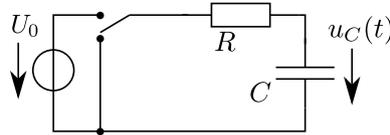
Die Kapazität ist bei Schalterstellung in obiger Position lange Zeit aufgeladen worden und wird nun durch umlegen des Schalters entladen.
