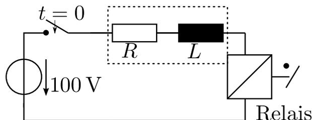
In der angegebenen Relaisschaltung wird der Schalter zum Zeitpunkt  $t = 0$  geschlossen. Die Wicklung des Relais ist durch den Widerstand  $R = 100 \Omega$  und die Induktivität  $L = 1 \text{ H}$  charakterisiert. Das Relais zieht bei einem Strom von  $I_a = 0,64 \text{ A}$  an.
