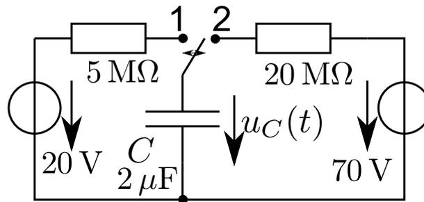
Der Schalter in o.g. Schaltung befindet sich seit langer Zeit in Position 1, bevor er zum Zeitpunkt  $t = 0$  für die Dauer von 30 s in Position 2 umgelegt wird, um dann wieder in Position 1 zurückgeschaltet zu werden.
