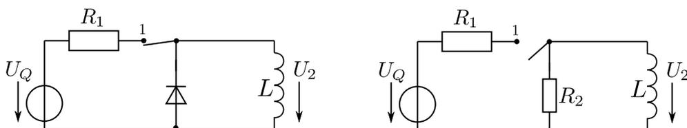
Der Schalter wird zum Zeitpunkt  $t = 0$  in die Position "1" gelegt, es wird dadurch die zunächst stromlose Spule  $L$  geladen. Nach einer Zeit  $t = t_1$  wird der Schalter umgelegt, so dass die Spule  $L$  über die Diode entladen wird. Das linke Schaltbild gibt ein mögliches Prinzip an, während im Rechten die Diode durch ihren Widerstand  $R_2$  ersetzt wurde. Dieses rechte Schaltbild ist ggf. zur Berechnung zu verwenden.
