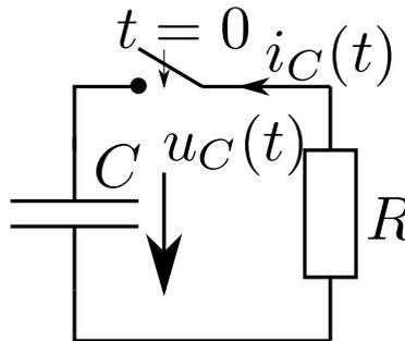
Eine Kapazität mit  $C = 1 \mu\text{F}$  ist auf die Spannung  $U_C = 100 \text{ V}$  aufgeladen. Die Kapazität wird über einen Widerstand  $R = 1 \text{ k}\Omega$  entladen, indem zum Zeitpunkt  $t = 0$  der Schalter geschlossen wird.
