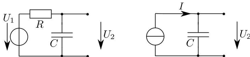
An eine RC-Schaltung wie oben gezeigt werden im ungeladenen Zustand verschiedene Quellen angelegt, geben Sie jeweils die Spannungsverläufe an!
