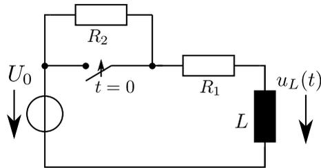
Mit geöffnetem Schalter treibt die Spannungsquelle schon für lange Zeit einen Strom durch  $R_1, R_2, L$ . Zum Zeitpunkt  $t = 0$  wird der Schalter geschlossen.
