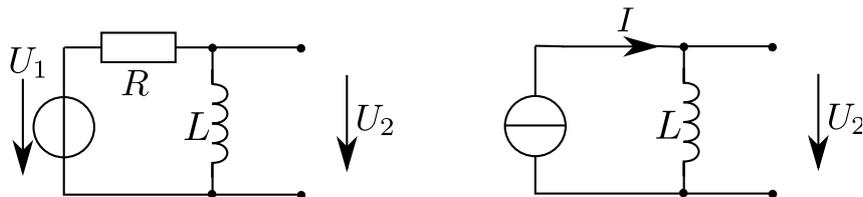
An eine LR-Schaltung wie oben gezeigt werden im ungeladenen Zustand verschiedene Quellen angelegt, geben Sie jeweils die Spannungsverläufe an!
