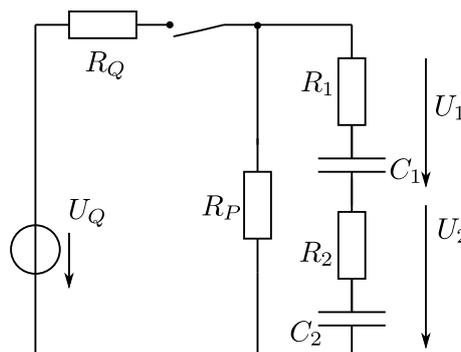
Zwei Kondensatoren (Kapazitäten mit Innenwiderständen  $C_1, R_1$  und  $C_2, R_2$ ) werden bei geschlossenen Schalter geladen. Zunächst seien die Kapazitäten ungeladen.
