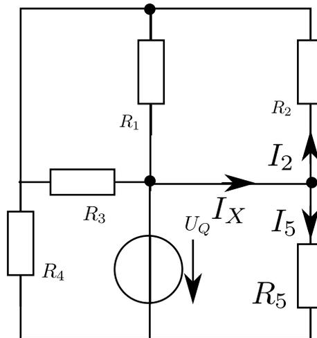
Die dargestellte Schaltung enthält die Widerstände  $R_1 = 50 \Omega$ ,  $R_2 = 45 \Omega$ ,  $R_3 = 40 \Omega$ ,  $R_4 = 55 \Omega$ ,  $R_5 = 60 \Omega$ . Die vorhandene Spannungsquelle liefert die Spannung  $U_Q = 48 \text{ V}$ . Wie groß ist der Strom  $I_X$ ?
