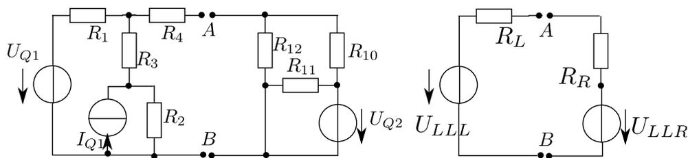
Berechnen Sie die Spannung  $U_{AB}$ . Teilen Sie dazu das Netzwerk an diesen Punkten in einen linken und einen rechten Teil auf und berechnen Sie jeweils die linksseitige und rechtsseitige äquivalente Spannungsquelle. Danach können Sie alles zu einer einfachen Masche wieder zusammenführen und die gesuchte Spannung berechnen. Das Ergebnis darf als Abkürzungen die Parameter der Ersatzquellen enthalten.
