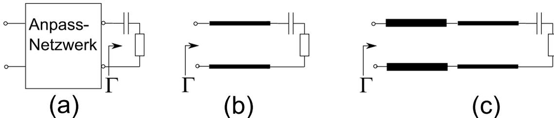
Die Reihenschaltung der Kapazität mit dem Widerstand hat bei der betrachteten Frequenz die Impedanz  $Z = 50\Omega - j100\Omega$ . Die Spannungsquelle hat eine Eingangsimpedanz von  $50\Omega$ , führen Sie sämtliche Berechnungen im Smith-Diagramm auf diesem Impedanzniveau aus.
