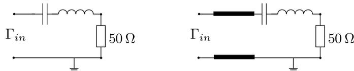
Ein einfacher Serien-Resonanzkreis (im obigen Bild links) hat einen Impedanzverlauf des Eingangreflexionsfaktors  $\Gamma_{in}$ , der im Smith-Diagramm gezeigt werden soll. Die Werte der Elemente sind  $C = 20 \text{ pf}$  für die Kapazität und  $L = 2 \text{ nH}$  für die Induktivität.
