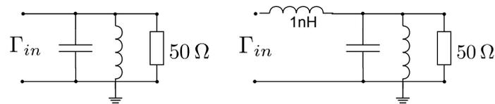
Ein Parallel-Resonanzkreis (im obigen Bild links) hat einen Impedanzverlauf des Eingangsreflexionsfaktors  $\Gamma_{in}$  wie im Smith-Diagramm gezeigt.
